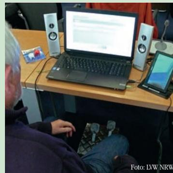
**Zu dem Simulator gehört neben Gas- und Bremspedal auch ein Tablet (re.), das während der Fahrt bedient werden muss**
